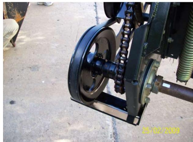
El soporte original tensor N° 1065218 S1 deberemos hacer un orificio en la posición que figura en la foto.
