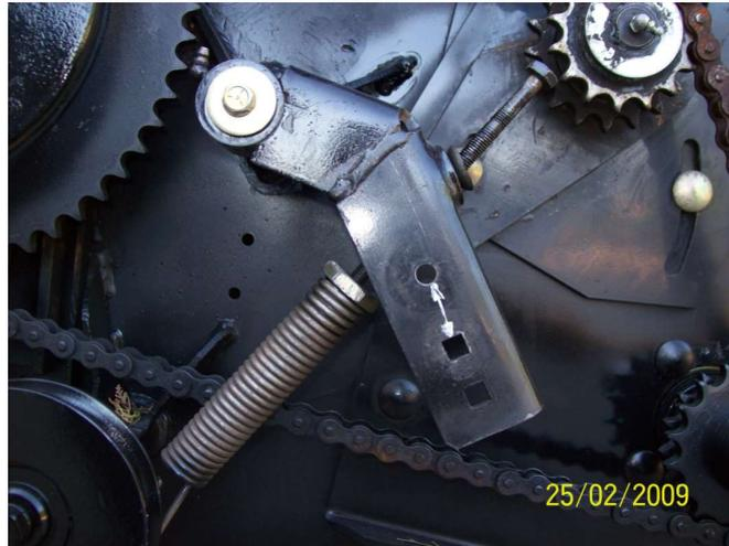
A 40 mm de su posición original sobre este orificio ira la polea tensora. Colocaremos la correa C126 y tensaremos la misma con el registro original, seguidamente apoyaremos polea tensora TP-CA212-104. Seguidamente colocaremos soporte original N° 39 (065812 S1) interponiendo pieza TP-CA212-202. Entre soporte y lateral plataforma, tornillo 12 x 1,75 x 55 con pieza TP-CA212-202 y 10 x 1,5 x 35 en su posición original.
