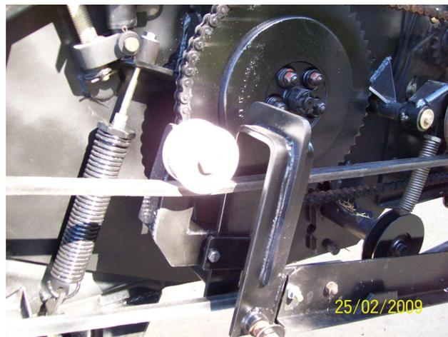
Colocar polea 125959 A1TPRF sobre eje de mando alineada con respecto a la caja TP-CA2012 y ajustar con cono original N° 48 C1MTA215
