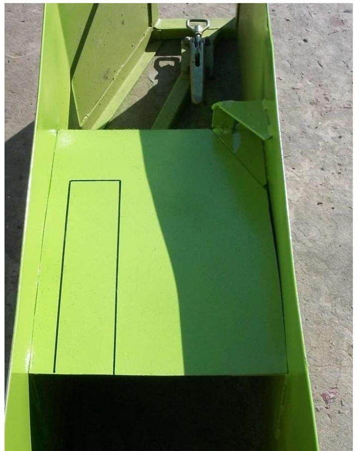
Una vez realizado dicho corte volveremos a usar la pieza TP-CA21403 para colocarla en la parte inferior para así reforzar la zona donde cortamos, lograr que los extremos de la U queden al ras de la chapa superior y así soldar unas puntadas cortas en todo su contorno en la parte inferior.
