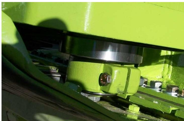
Colocar correa, verificar su tención y reajustar después de las primeras horas de trabajo.
