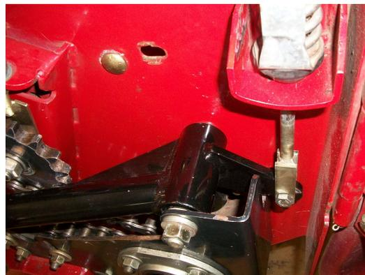
Colocar la correa **C122**, regular la tensión con el registro original, controlar su alineación, regular por medio de suplementos y arandelas originales.
