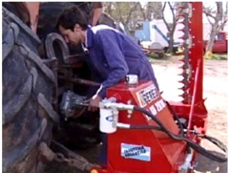
3) El multiplicador posee también una traba anti rotación (de color amarillo). De sus dos extremos colocaremos dos cadenas que irán sujetas en algún punto fijo del tractor, se recomienda que esta traba no quede totalmente fija, sino que tenga un leve movimiento de rotación en su arranque ( +/- 2,5 cm)
