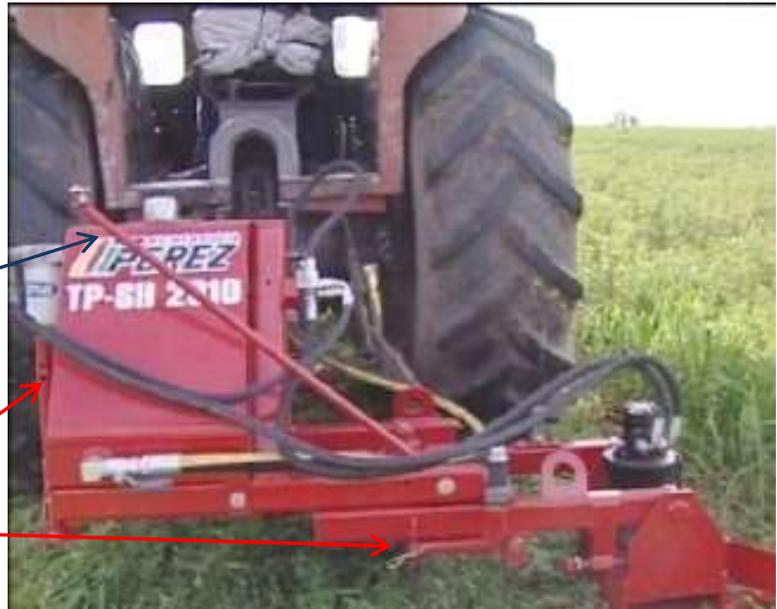
6) Es recomendado para un buen funcionamiento que la cuchilla de corte este levemente inclinada hacia adelante de 0 a 10°.
