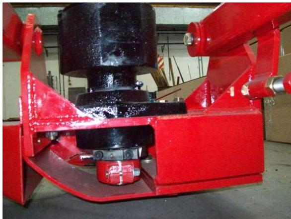
7) Atención: en el chasis superior encontrará una calco con la palabra “fusible”, es un tornillo que evita el movimiento pivot del chasis inferior.
